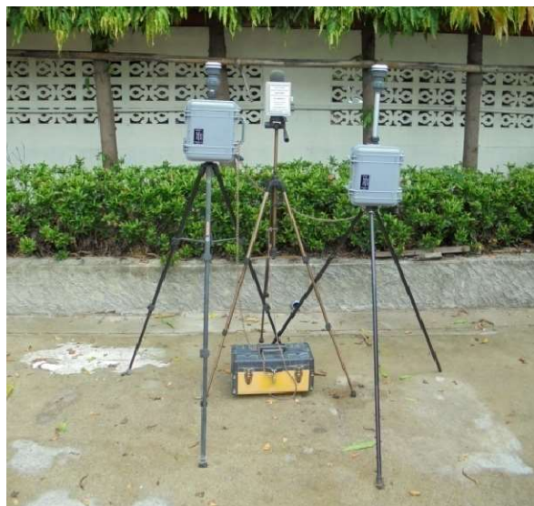
ติดตั้งเครื่องตรวจวัดฝุ่นละออง แบบ Gravimetric method , เครื่องตรวจวัดระดับเสียง Integrating Sound Level meter และเครื่องตรวจวัดแรงสั่นสะเทือน บริเวณวัดลานบุญ
